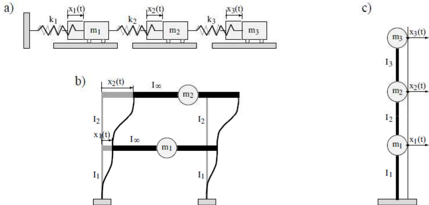
Oscillateurs multiples à trois (ou deux) masses concentrées sans amortissement. Représentation traditionnelle orientée mécanique (a) et représentations orientées structure (b, c).
