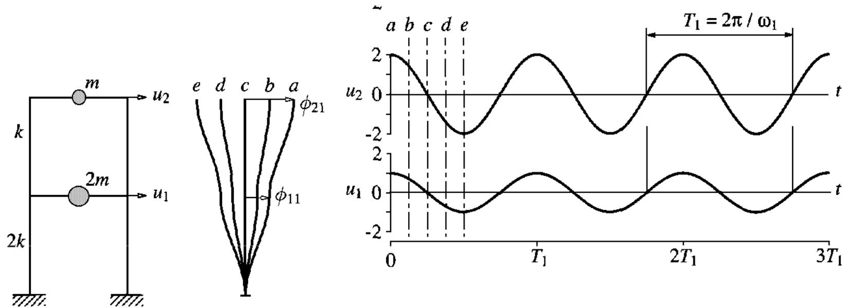
Le mouvement est décrit par une même **fonction harmonique**  $q_1(t)$  de période  $T_1$  avec amplitudes **différentes**..
