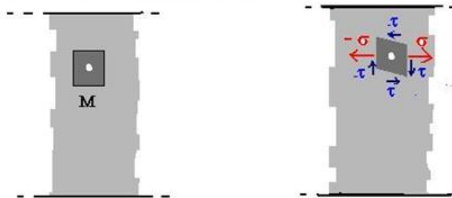
Effet des contraintes sur un cube élémentaire entourant un point de la poutre
