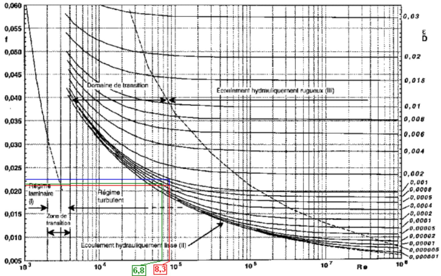
*Diagramme de Moody : Coefficient de frottement dans les tuyauteries,  $\lambda$ , en fonction du nombre de REYNOLDS,  $Re$ , et de la rugosité relative,  $D/\epsilon$*
