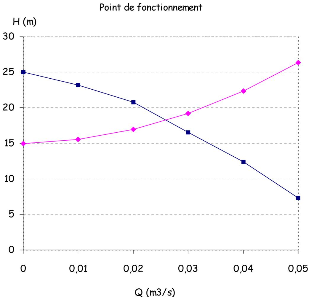
L'intersection entre les deux courbes définit le point de fonctionnement A :  $Q \approx 0,026 m^3/s = 26 l/s$  et  $H \approx 18,5 m$ .
