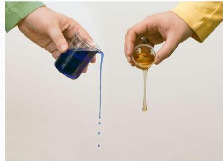
La viscosité d'un fluide en mouvement est la propriété qui exprime sa résistance à une force tangentielle.
