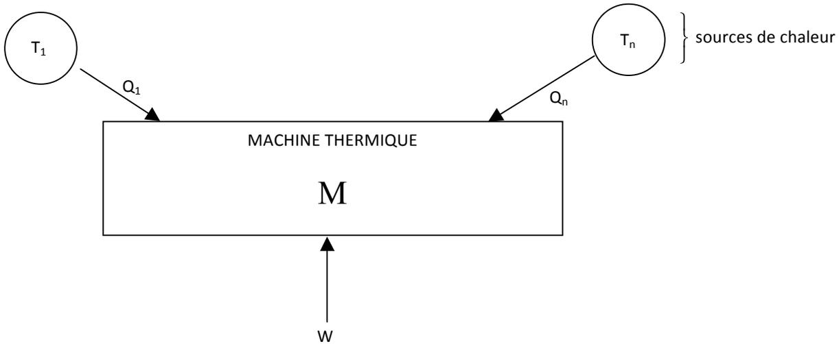
si  $W > 0$ , la machine est un **récepteur**.
