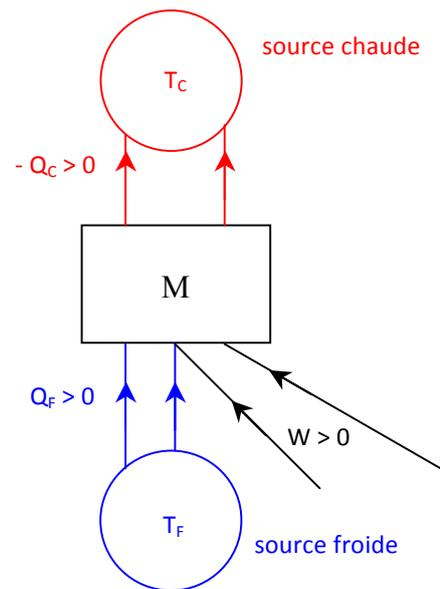
La source utile est la source froide :  $e \leq \frac{1}{\frac{T_C}{T_F} - 1}$
