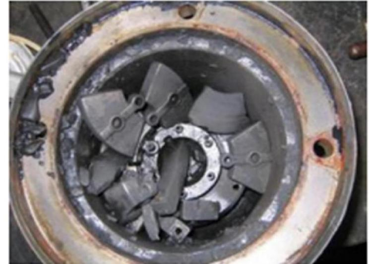
*Rupture des aubes d'une pompe*
