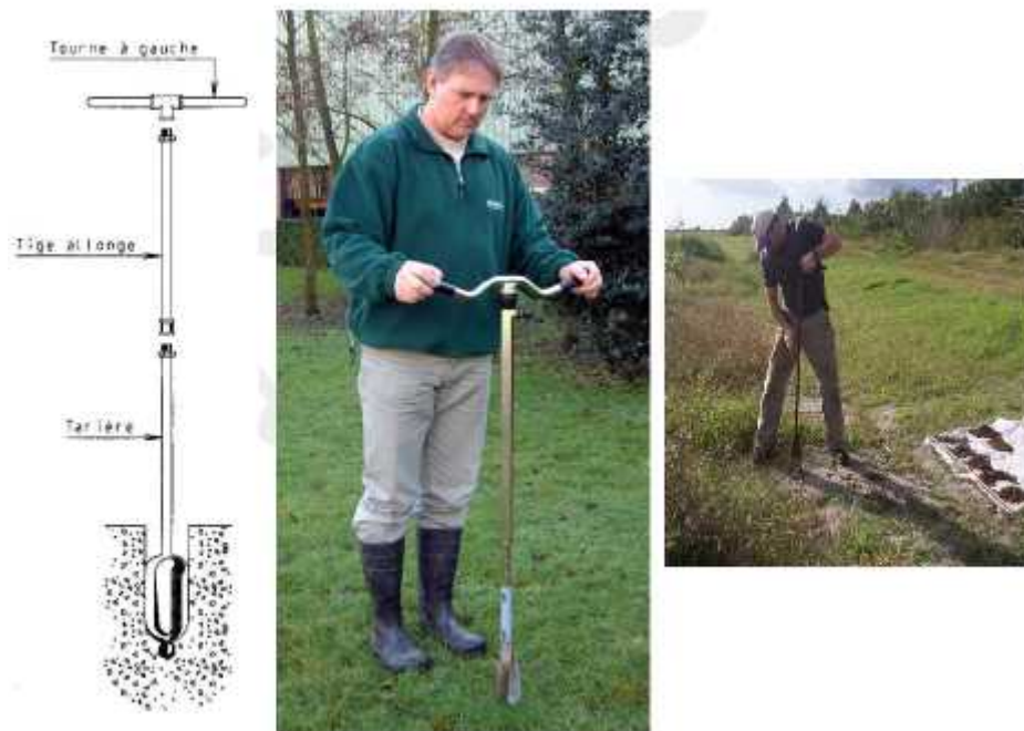
Figure 3. Forage à la tarière manuelle
