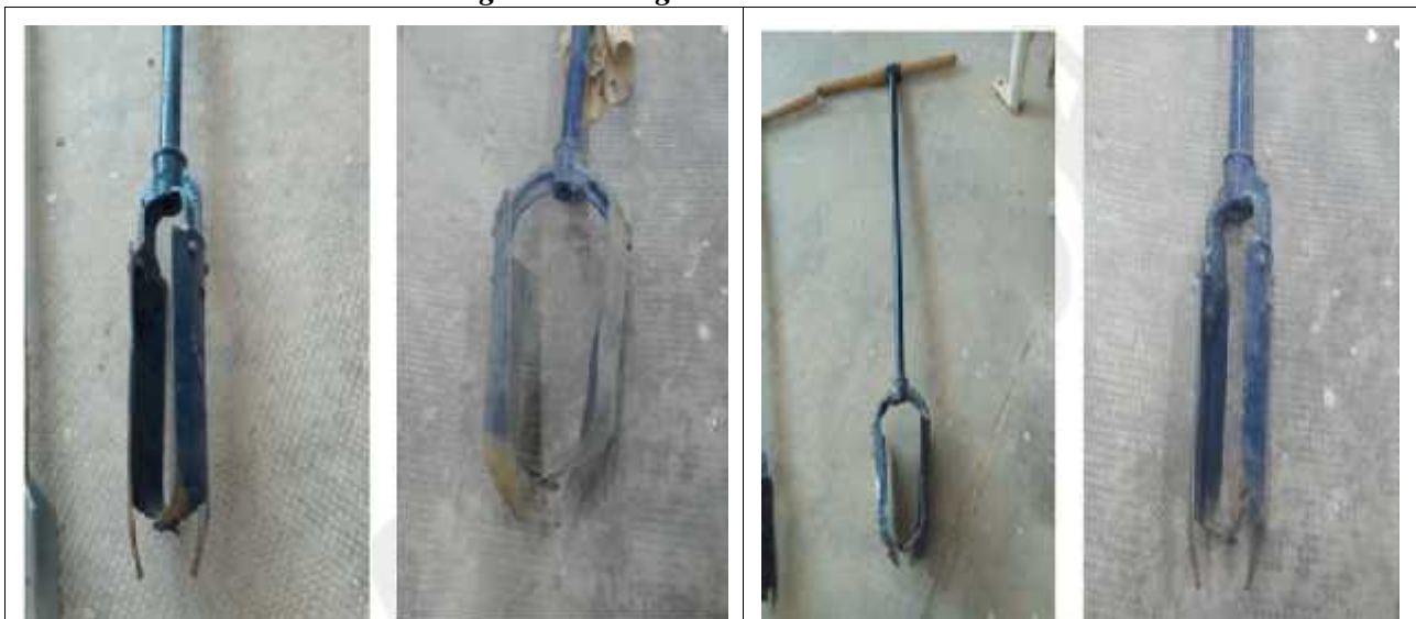
Figure 4. Les tarières à mains du labo géotechnique.
