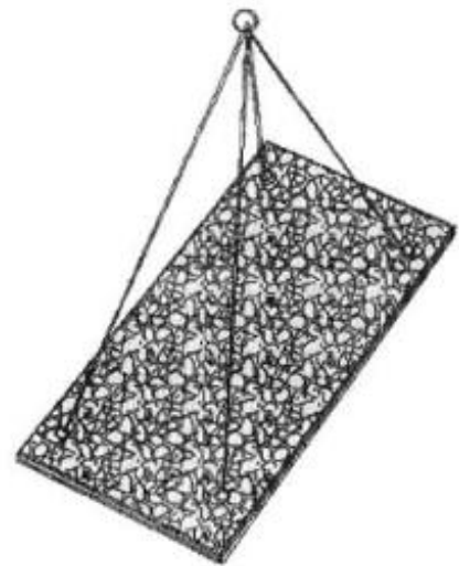
Utilisation d'un palonnier à brins d'élingues multiples.
