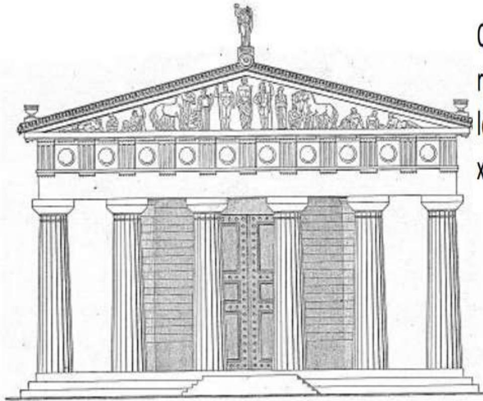
On note l'apparition d'un schéma canonique (qui revient pour tous les temples de l'époque) selon lequel les colonnes sont établies sur l'idéal  $n \times (2n+1)$ . Ici, c'est un 6x13 colonnes.
