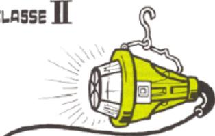
La classe II (deux) : On a réalisé une double isolation ou une isolation renforcée. Il n'y a pas de raccordement à la terre.
