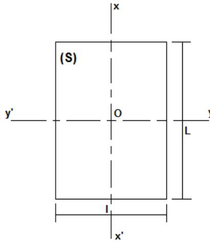
$\mathbf{CM}_R = \frac{I_{S/x'x}}{V_{\text{carène}}}$  où  $x'x$  est donc l'axe longitudinal de la flottaison S passant par son centre de gravité O
