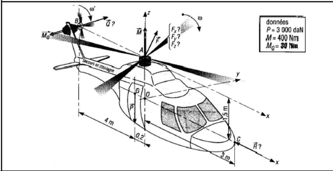
**Résolution** : isolons l'ensemble de l'hélicoptère et appliquons le principe fondamental. L'hélicoptère est soumis à l'action de quatre torseurs d'actions extérieures :
