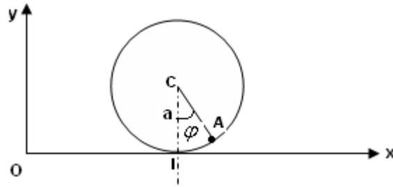
Une bille A, assimilée à un point matériel de masse m, peut se déplacer librement sans frottement sur un cerceau (C) (masse m, rayon a et centre C) grâce à une liaison bilatérale parfaite. Le cerceau est astreint à se déplacer dans un plan vertical fixe en roulant sans glisser sur l'axe Ox,  $\varphi = (ox, CA)$ ,  $\theta$  est l'angle de rotation propre du cerceau.
