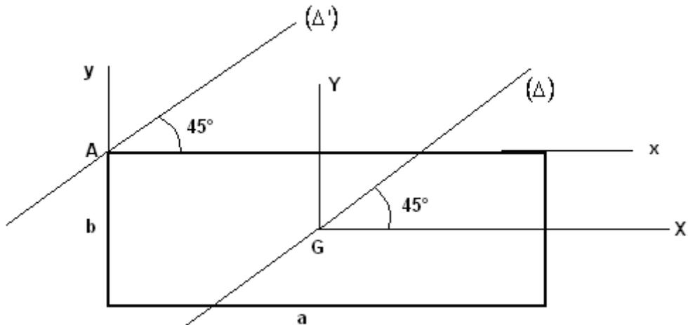
b- Calculer le moment d'inertie de la plaque par rapport à un axe  $(\Delta)$  passant par  $G$  et faisant un angle de  $45^\circ$  avec  $GX$ .
