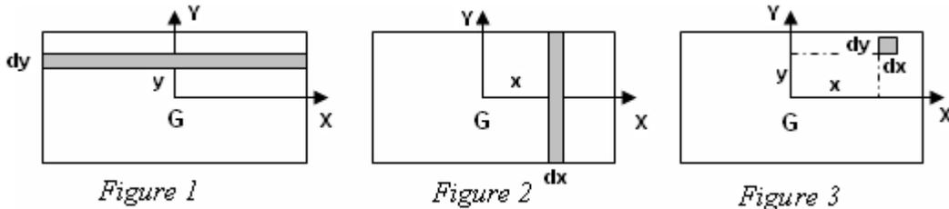
Le solide est une plaque de dimension  $a \times b$ . Sa surface est  $S = ab$ , sa Masse :  $M = \lambda S$
