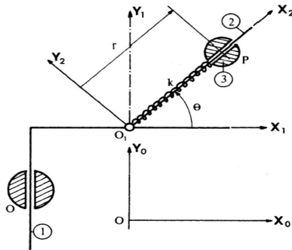
Toutes les liaisons sont parfaites. La raideur du ressort est  $k$  et sa longueur à vide est  $r_0$ . La masse de (3) est  $m$ . Le mouvement de  $O_1$  est tel que  $OO_1 = \frac{1}{2} \gamma t^2 \vec{Y}_0$ .
