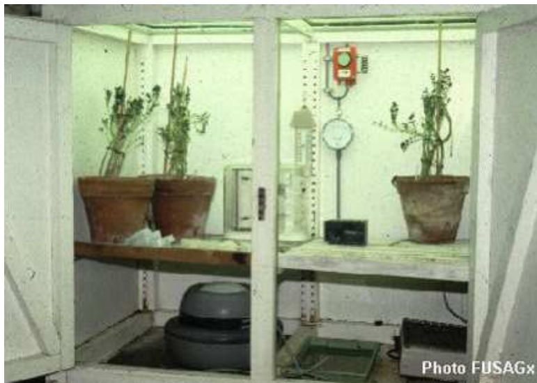
Chambre artisanale de thermothérapie maintenant les plantes à une température d'environ 39°C et dans une atmosphère humide pendant 3 semaines
