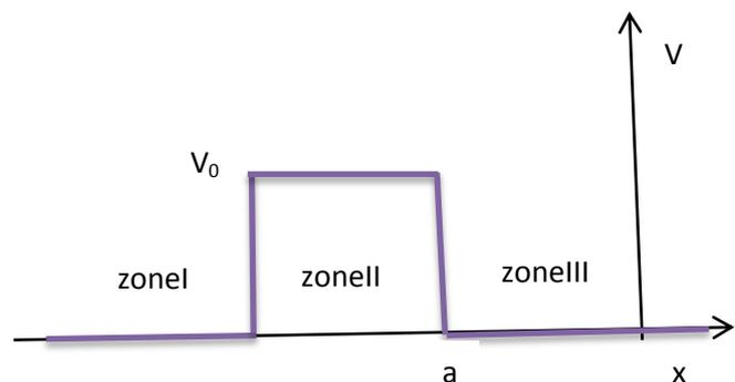
Une particule de masse m d'énergie E venant de  $-\infty$  se dirige vers  $+\infty$ . On suppose que l'énergie de la particule est inférieure à  $V_0$ . En mécanique classique la particule est réfléchi par la barrière du potentiel.
