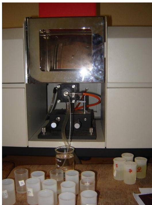
**Fig. 5 :** un modèle d'atomiseur-flamme (Rayleigh WFX-130)
