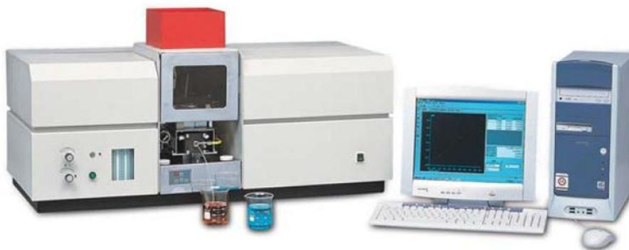
**Fig. 1** : Spectrophotomètre d'absorption atomique (SAA)
