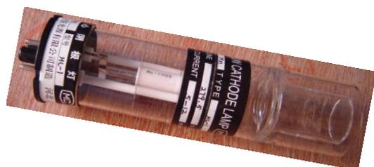
**Fig. 4 :** Lampe à cathode creuse du spectrophotomètre d'absorption atomique (Rayleigh WFX-130)
