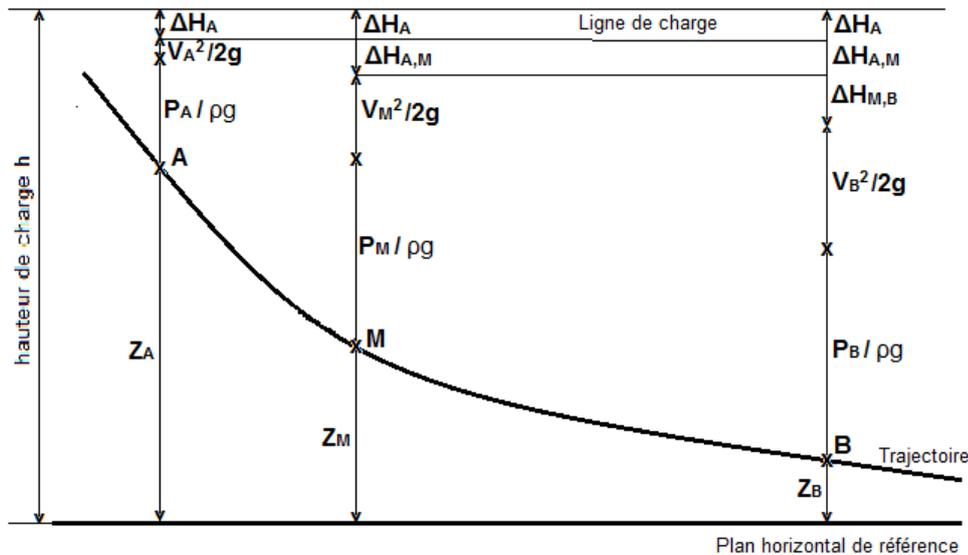
**Remarque :** les pertes de charge augmentent et se cumulent lors d'un écoulement.
