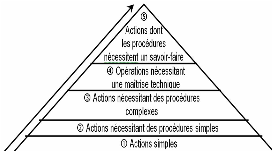
Figure 3: Triangle des niveaux des actions de maintenance
