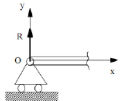
2) **Appui double (articulation)** : Matérialisé par une rotule. Cet appui autorise les rotations d'une extrémité de la poutre ou d'un des éléments constituant la structure. La direction de la réaction  $R$  est inconnue, mais la ligne d'action passe par le centre de l'articulation. L'articulation introduit 2 inconnues, par exemple les projections sur deux directions du plan moyen.
