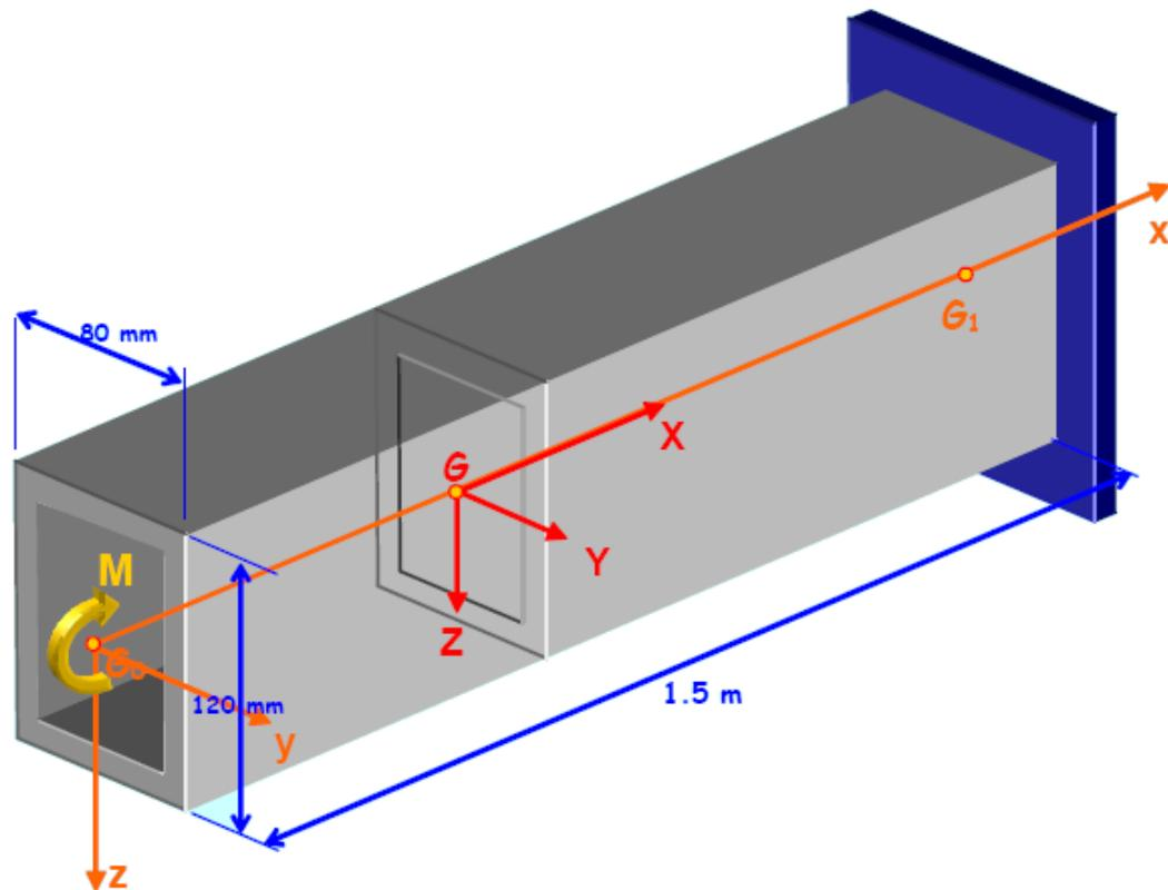
Le moment de flexion  $M_y = +M$  est constant tout au long de la poutre  $G_0G_1$ . Toutes les sections sont donc équidangereuses. Considérons une section quelconque  $G$ . les axes  $Y$  et  $Z$  sont principaux d'inertie pour la section tubulaire  $G$  (axes de symétrie).
