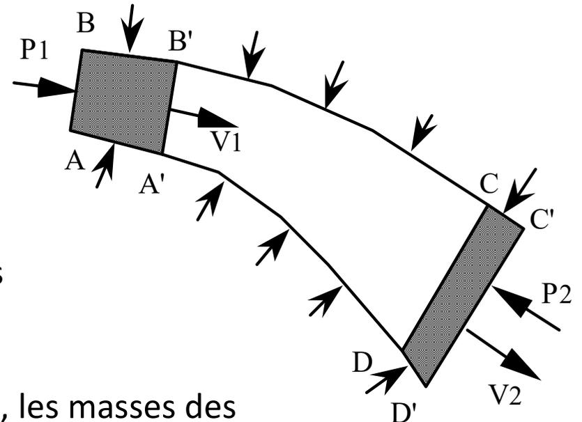
Soit  $q$  le débit en masse du tube de courant considéré, les masses des éléments  $ABB'A'$  et  $CDD'C'$  sont égales à  $q \cdot dt$ . La variation de quantité de mouvement durant l'intervalle de temps  $dt$  est donc :
