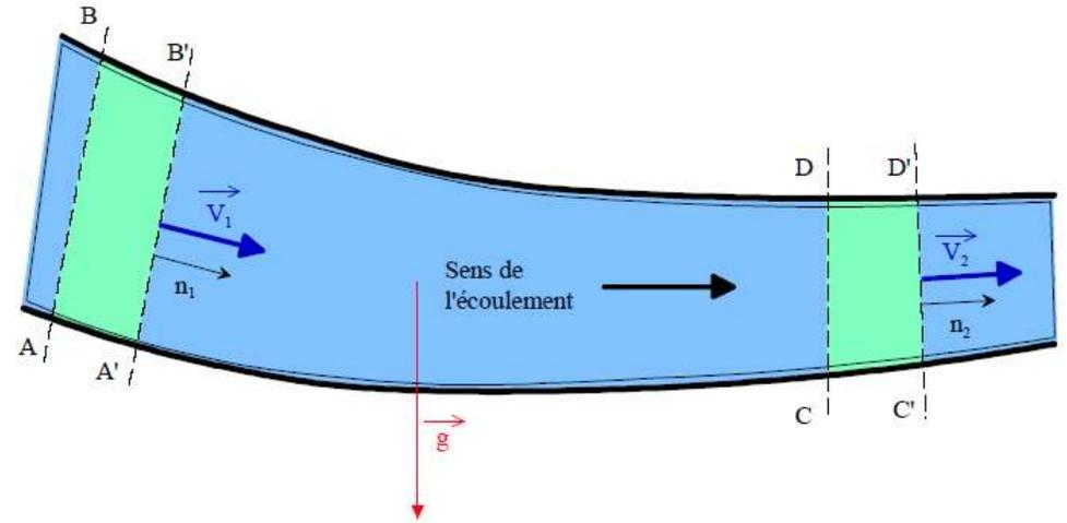
La relation fondamentale de la dynamique nous dit que pour modifier d'une petite quantité la vitesse d'un élément de masse  $m$  entre deux instants très proches  $dt$ , il faut appliquer une force  $F$ . Nous obtenons  $F = m \cdot \frac{dV}{dt}$  avec  $\frac{dV}{dt} = \gamma$  (accélération)
