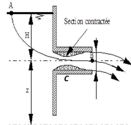
La **perte de charge** entre A et B résulte essentiellement de la variation des sections offertes à l'écoulement et on peut l'estimer à :
