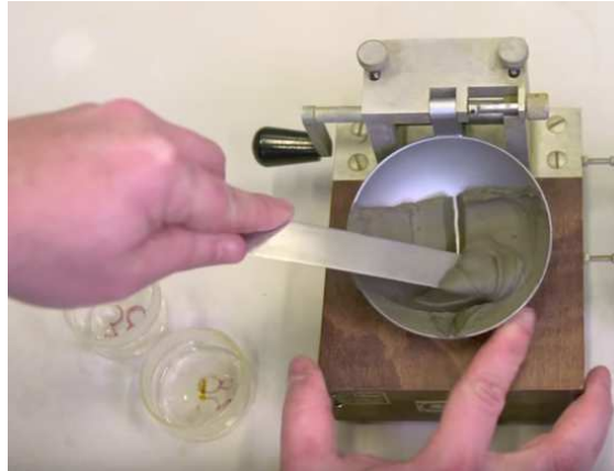
Figure 2.7 Prélèvement de la pâte à l'endroit de la fermeture de la rainure [8].
