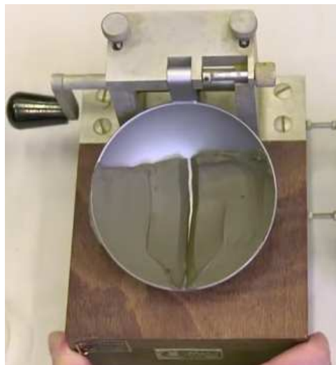
Figure 2.6 Fermeture de la rainure après un nombre N de chocs [8].
