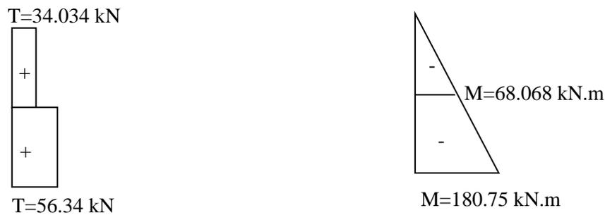
**Figure 5-1. Diagrammes des efforts tranchant (T) et des moments fléchissant (M) à  $t=T_2$**
