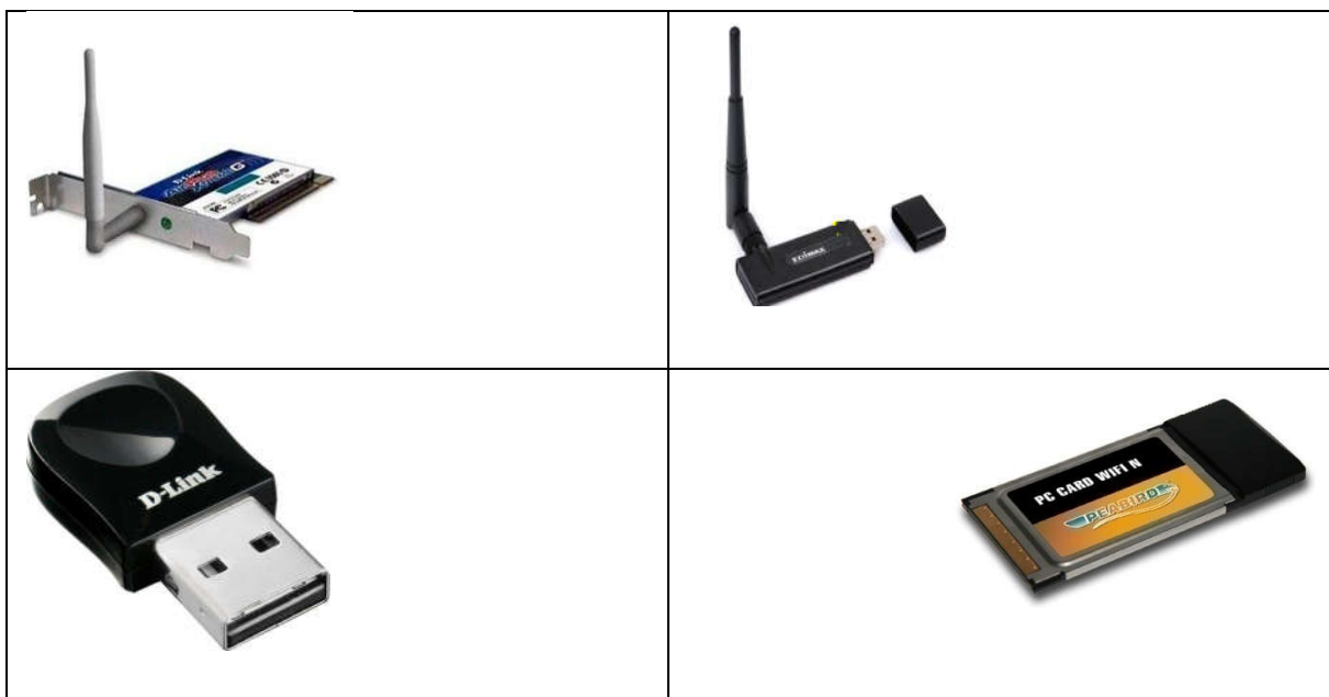
Figure II.4 : Types des cartes réseaux sans fil
