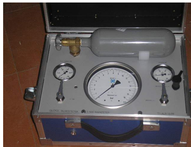
Figure III.33. Mesure de la pression interstitielle au niveau d'une cellule pneumatique [70].
