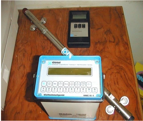
Figure III.23. Appareil de lectures brutes inclinométriques [70].
