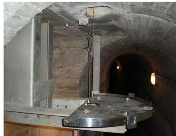
Figure III.19. Installation d'un pendule avec table de lecture dans une galerie [100].
