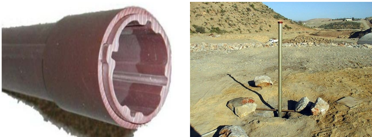
Figure III.22. Tube inclinométrique avec rainures de guidage [70].
