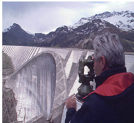
Figure III.9. Visée de bornes d'observations pour mesure des déplacements.
