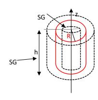
Remarque: Dans le cas d'un cylindre on ne peut pas calculer les constantes C<sub>1</sub> et C<sub>2</sub> car le potentiel à l'infini est non nul.
