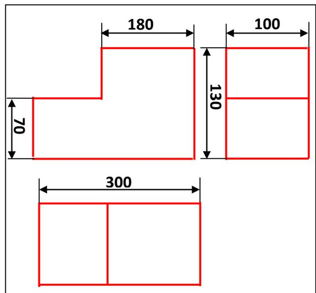
Sur la représentation suivante, certaines mesures sont en vraie grandeur (**V.G**) par contre d'autres ne le sont pas, d'où la nécessité de bien choisir les plans de projection.
