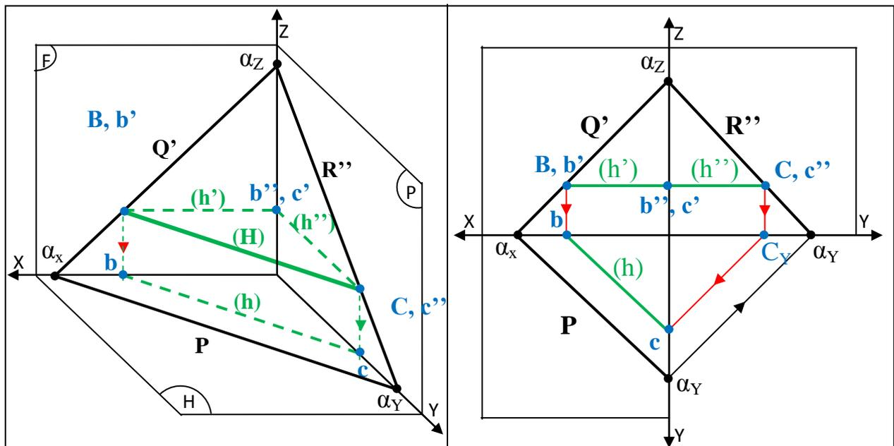
Une horizontale d'un plan a les mêmes caractéristiques qu'une droite horizontale donc elle se projette de la façon suivante ;
