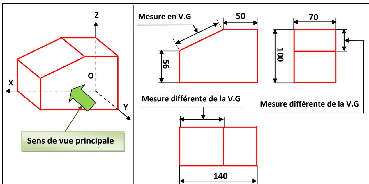
Dans la géométrie de l'espace, pour la représentation des objets, et en fonction de l'importance des détails à mettre en évidence par rapport à d'autres, plusieurs méthodes de représentation peuvent être utilisées,
