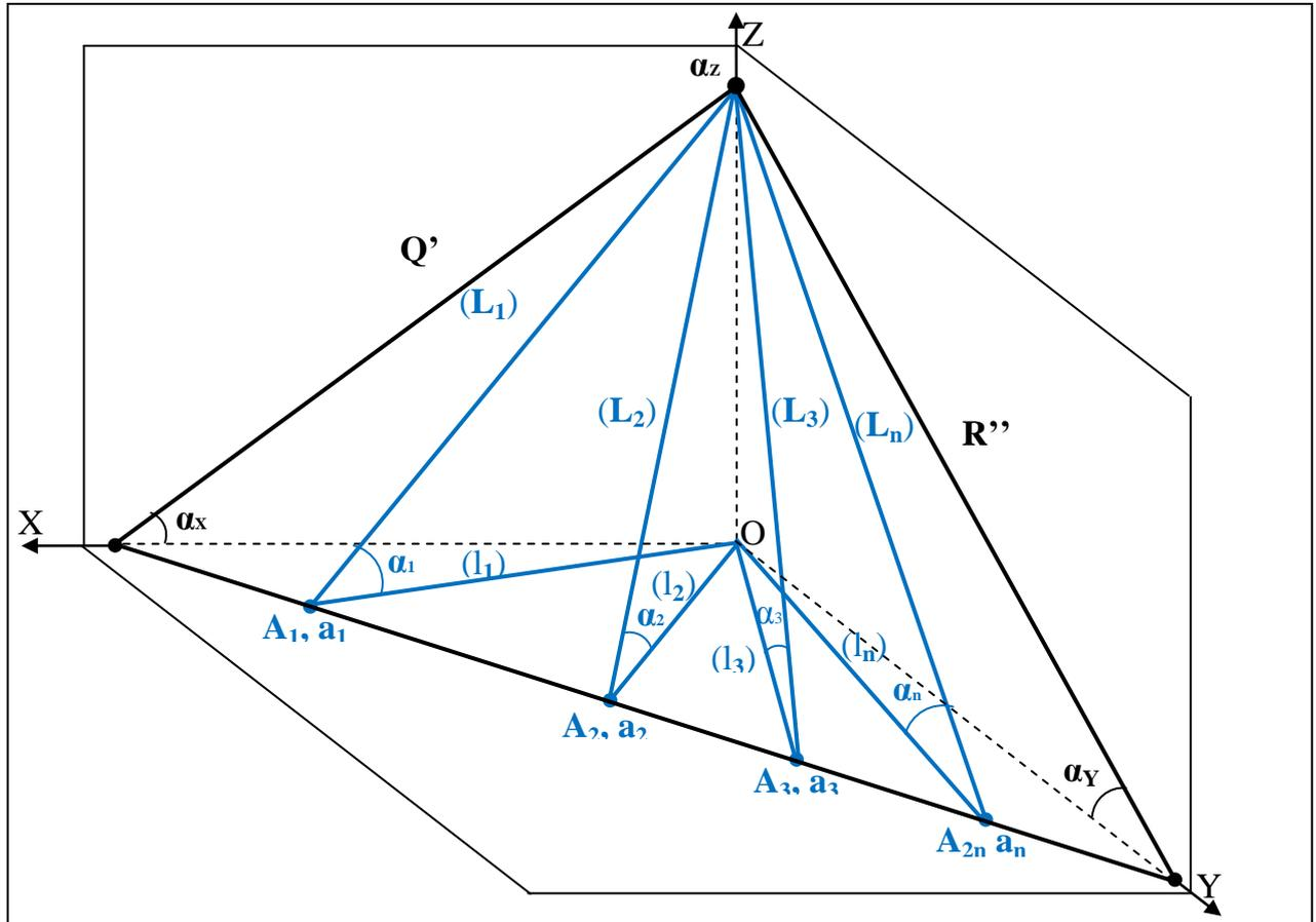
Nous considérons  $(L_1), (L_2), \dots, (L_n)$  des droites d'un plan passant par le même point  $\alpha_z$ ; les pentes de ces droites sont les angles entre la droite et sa projection horizontale. Nous considérons les triangles
