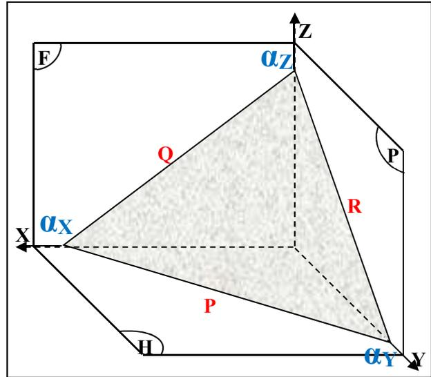
**P** : c'est la droite d'intersection de ce plan avec le plan de projection  $(H)$ .
