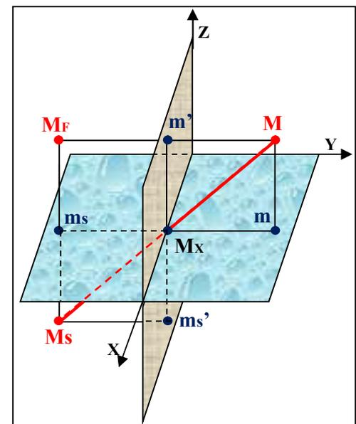
**Remarque :** le point symétrique par rapport à la ligne de terre est une double symétrie, l'une par rapport au plan frontal, l'autre par rapport au plan horizontal.
