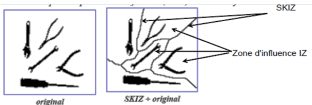
Figure.IV.3. Zone d'influence géodésique et SKIZ géodésique
