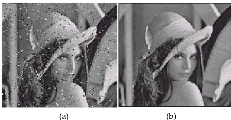
Figure.II.12. Elimination du bruit par le filtre alterné ;(a) image originale bruitée ; (b) image filtré par le filtre alterné \varphi\gamma
