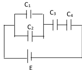
On donne :  $C_1 = 1\mu F$   $C_2 = 2\mu F$ ;  $C_3 = C_4 = 3\mu F$  et  $E = 12V$
