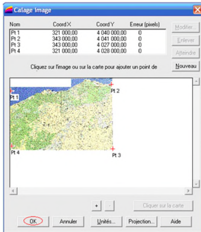
Figure 2.12 : Calage d'une image raster : 6 ème étape : Calcul de l'erreur de calage
