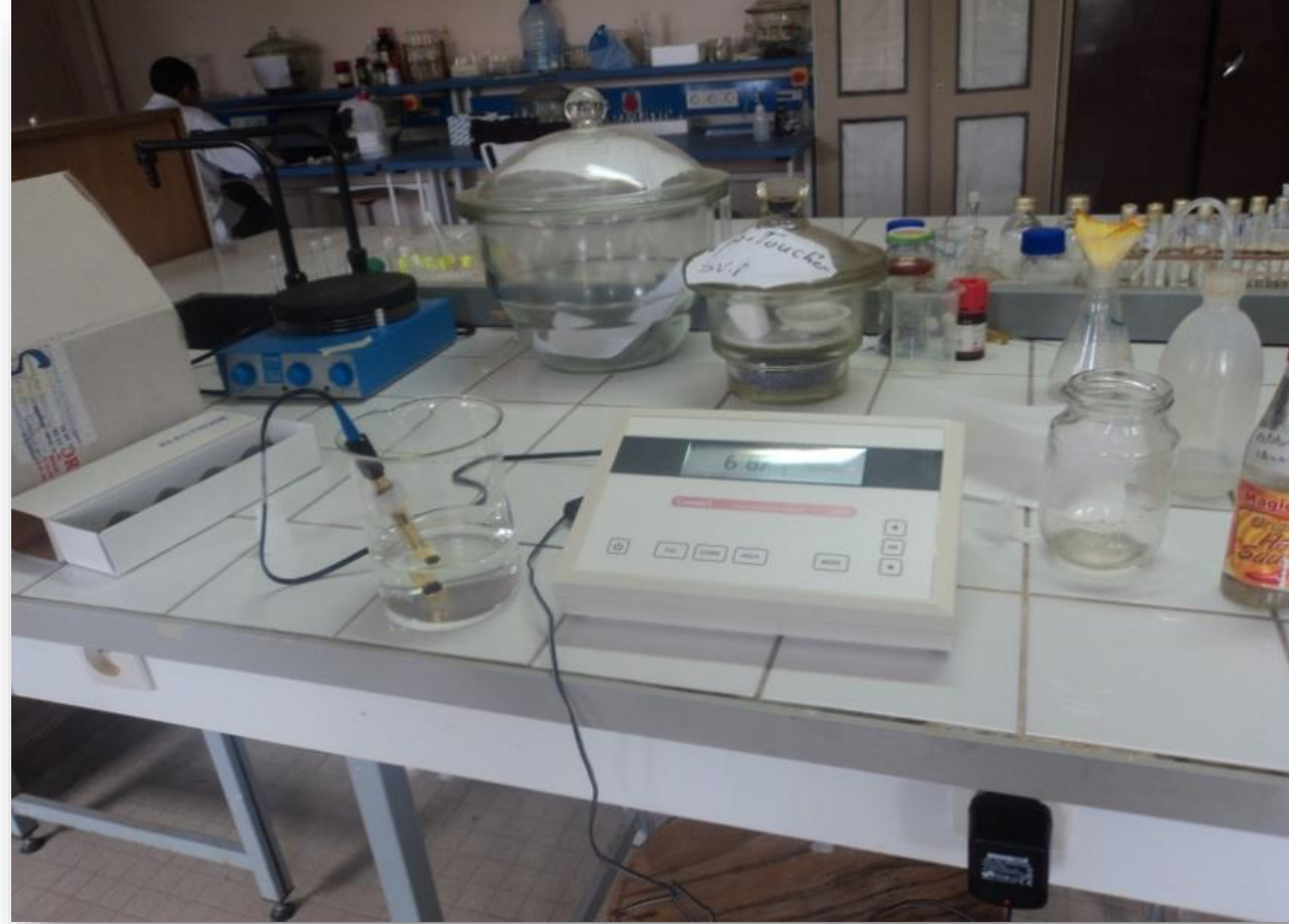
طريقة قياس نسبة الحموضة في مياه الأمطار.
