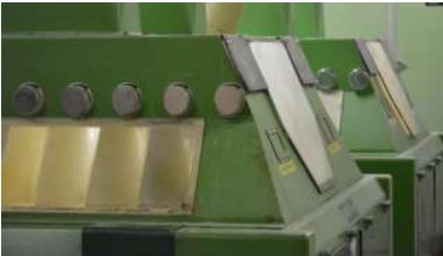
**2-Blutage ou tamisage** : C'est une opération basée sur la séparation des produits selon leurs dimensions. Cette opération s'effectue après chaque passage dans un appareil à cylindre. Elle permet le classement des produits en différentes tailles. Le passage des éléments à travers le tamis constitue l'extraction (les semoules), par contre ce qui reste sur le tamis c'est le refus (les sons).
