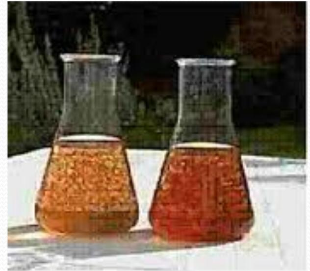
En plus de la détermination la dose de la coagulation, les essais de jar-test permettent de visualiser la floculation et de connaître ses effets aussi bien sur l'eau décantée que sur les boues. Ils doivent être effectués à une température voisine de celle que possédera effectivement l'eau au cours de son traitement in situ.
