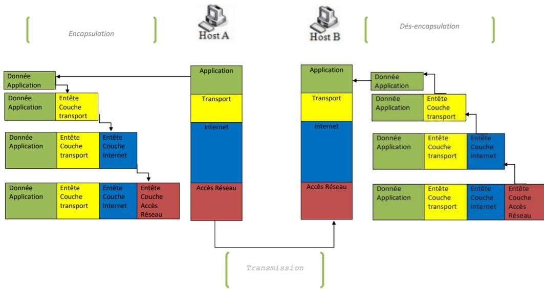
Figure II.9. Modèle TCP /IP (b) - Encapsulation
