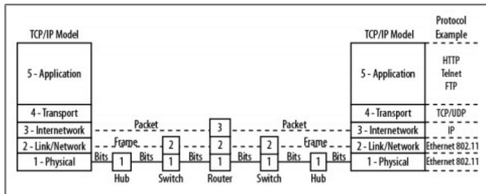
Figure II.10. Niveau d'opération des équipements réseau<sup>5</sup>
