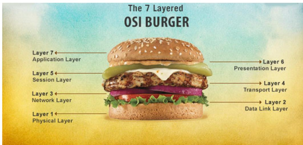
Figure 1. Le modèle en couche de OSI
