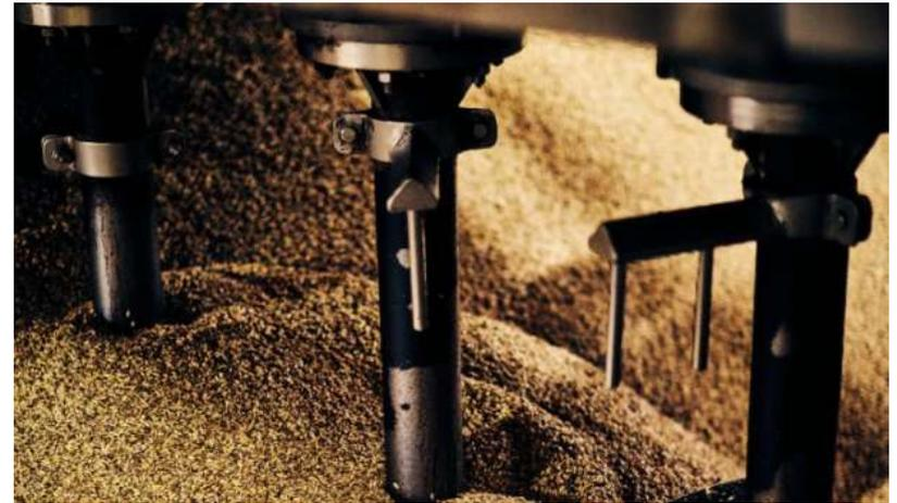
Avant l'étape de maltage, **le stockage** de l'orge brassicole dans les silos est une étape délicate. Pour préserver la capacité des grains à germer, on les refroidit. La transformation d'orge en malt dure environ 8 jours. La bonne conservation des grains par refroidissement permet d'étaler la production de malt tout au long de l'année, alors que la récolte est saisonnière.
