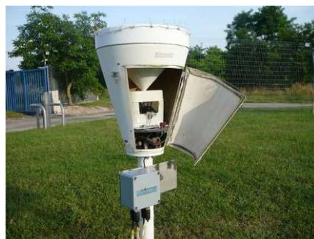
*Pluviomètre à augets basculants,
