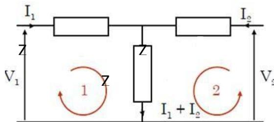
$$\begin{cases} V_1 = Z_1 I_1 + Z_2 \cdot (I_1 + I_2) = (Z_1 + Z_2) I_1 + Z_2 I_2 \\ V_2 = Z_3 I_2 + Z_2 \cdot (I_1 + I_2) = Z_2 I_1 + (Z_2 + Z_3) I_2 \end{cases}$$
