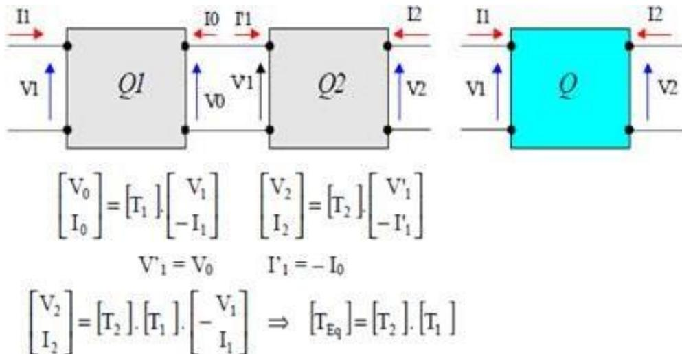
La matrice de transfert du quadripôle équivalent est donc égale au produit de la seconde.
