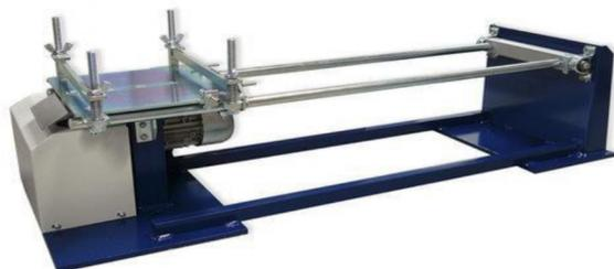
*Figure 7 : Appareil à chocs.*
