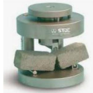
*Figure 4 : Presse de compression de ciment avec son dispositif de compression*
