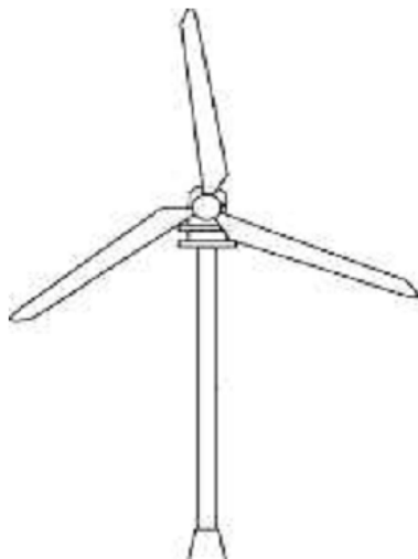
Figure I.6 : éolienne à axe horizontal
