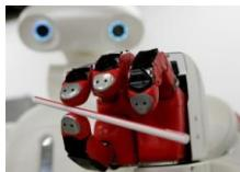
Le robot de la NASA nommé LEMUR (Limbed Excursion Mechanical Utility Robot) a été conçu pour être capable de construire, d'inspecter et d'entretenir des structures en orbite autour de la Terre. Une version réduite pourrait aider à la construction de grandes structures dans l'espace.
