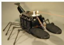
Ce robot expérimental appelé RED permet la surveillance et l'exploration. Il dispose d'un équipement qui lui octroie une vision en trois dimensions. IL est destiné à l'exploration planétaire.
