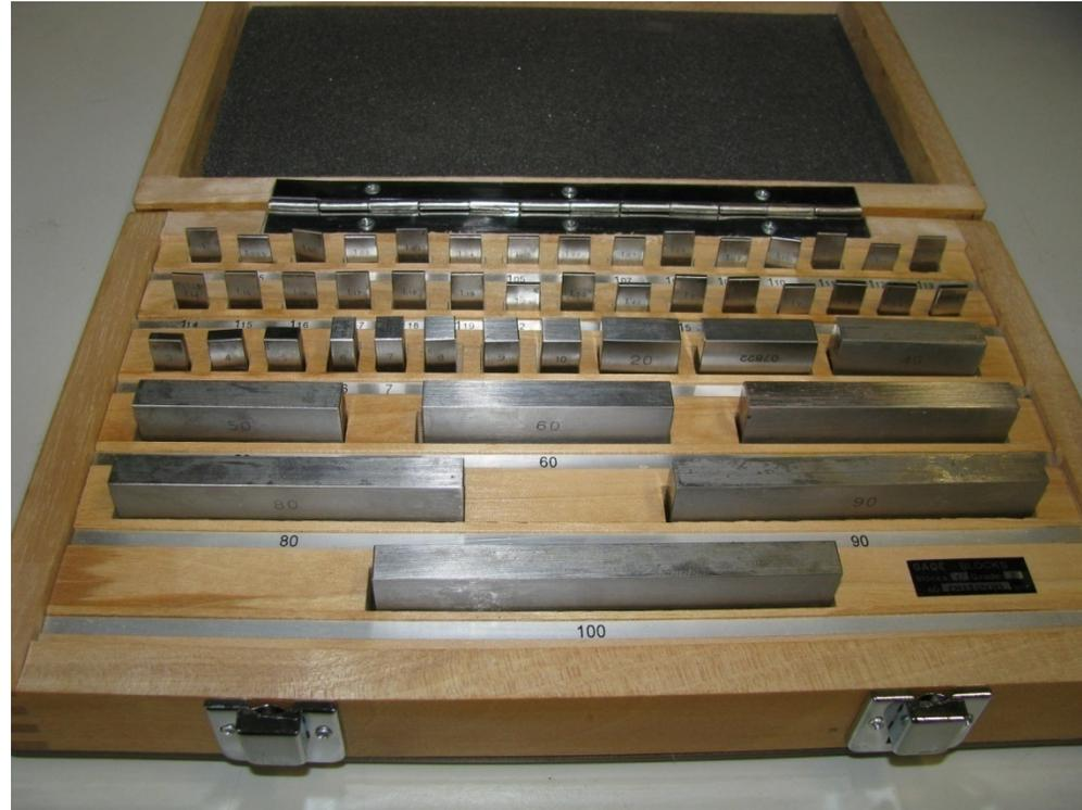
Les cales étalon sont des parallélépipèdes généralement en acier dont la longueur entre deux des faces (appelées mesurandes) est parfaitement connue. Les cales étalons sont utilisées pour étalonner ou régler des appareils de mesure de longueur.
