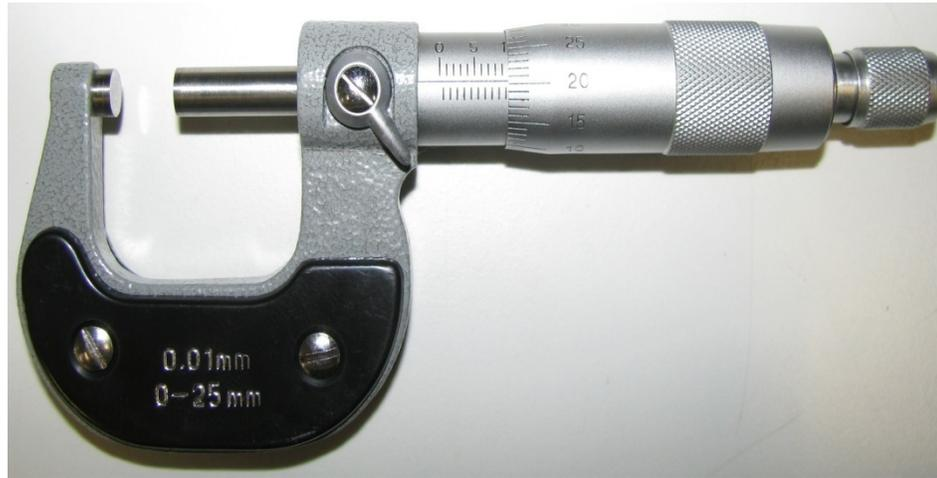
Le micromètre **0-25 mm**. Il permet de mesurer des épaisseurs entre 0 mm et 25 mm.
