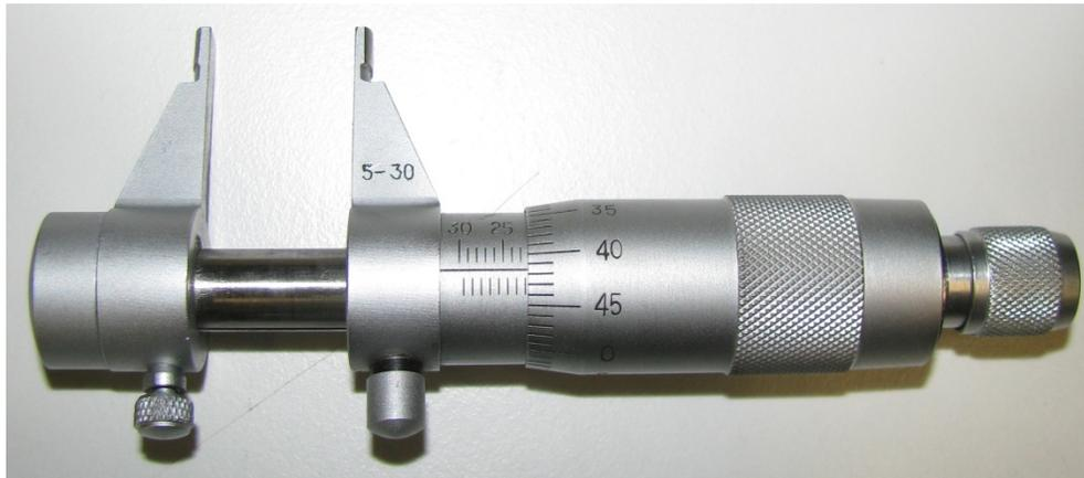
Le micromètre 5-30 mm. Il permet de mesurer des épaisseurs entre 5 mm et 30 mm.
