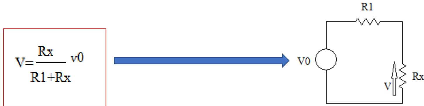
La relation qui lie la tension de sortie ( $V_0$ ) au paramètre image du mesurande ( $R_x$ ) n'est pas linéaire. La sensibilité du montage n'est donc pas constante.
