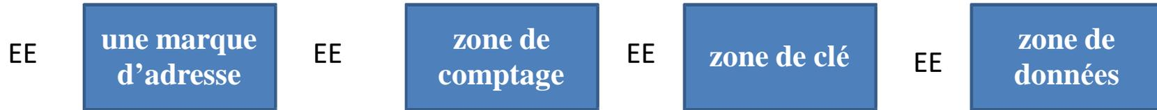
Schéma: Format d'un enregistrement physique
