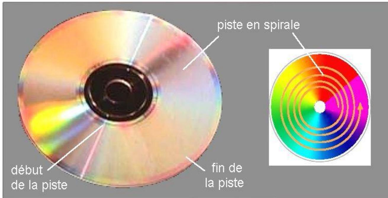
Les informations sont gravées sur un sillon unique, appelé piste. Enroulée en spirale, elle commence au centre du disque. Les bosses du support en polycarbonate apparaissent pour le faisceau laser comme des cuvettes : on appelle creux (en anglais pit) ou cuvette le fond de l'alvéole, on nomme plat (en anglais land) les espaces entre les alvéoles
