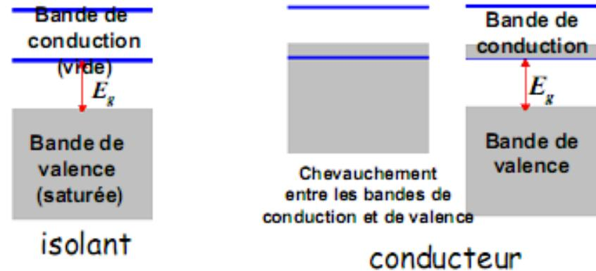
Semi-conducteur = propriétés intermédiaires entre isolant et conducteur / un e- puisse passer dans la bande de conduction par agitation thermique ou par l'application d'un champ électrique.
