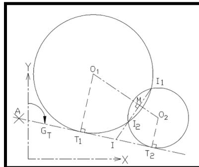
On cherche les deux cercles tangents à une droite donnée et passant par deux points connus  $I_1$  et  $I_2$  non situés sur cette droite. Les données sont les points  $A$ ,  $I_1$ ,  $I_2$  et le gisement  $G_T$ .
