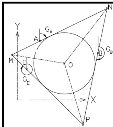
On cherche le cercle tangent à trois droites données. Il faut être attentif à l'orientation des tangentes suivant le quadrant du point de tangence. Les données sont les trois droites définies respectivement par les coordonnées de trois points A, B et C et les gisements des trois directions  $G_A$ ,  $G_B$  et  $G_C$ .
