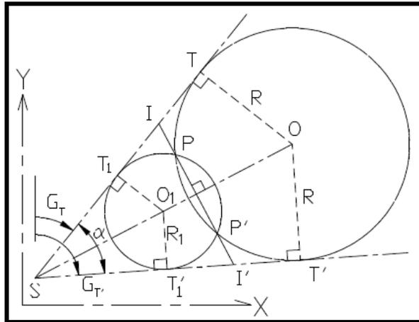
C'est un cas pratiquement identique à celui qui précède, sauf que le rayon est inconnu mais on impose un point de passage fixe P appelé « point obligé », un passage à niveau par exemple. Les données sont les coordonnées des points S et P, les gisements  $G_T$  et  $G_{T'}$ .
