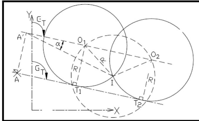
On cherche les deux cercles de même rayon  $R$  connu centrés en  $O_1$  et  $O_2$ , passant par le point  $I$  et tangents à une droite donnée ne passant pas par  $I$ . Les données sont les points  $I$  et  $A$ , le gisement  $G_T$  et le rayon  $R$ .
