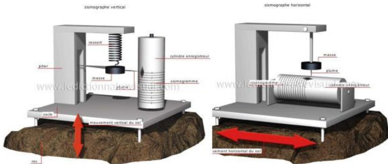
Figure 23. Schémas des sismographes : vertical et horizontal (source : ikonet.com)
