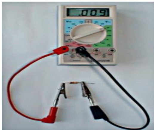
Figure I.5. Mesure de la résistance par un Ohmmètre [5].
