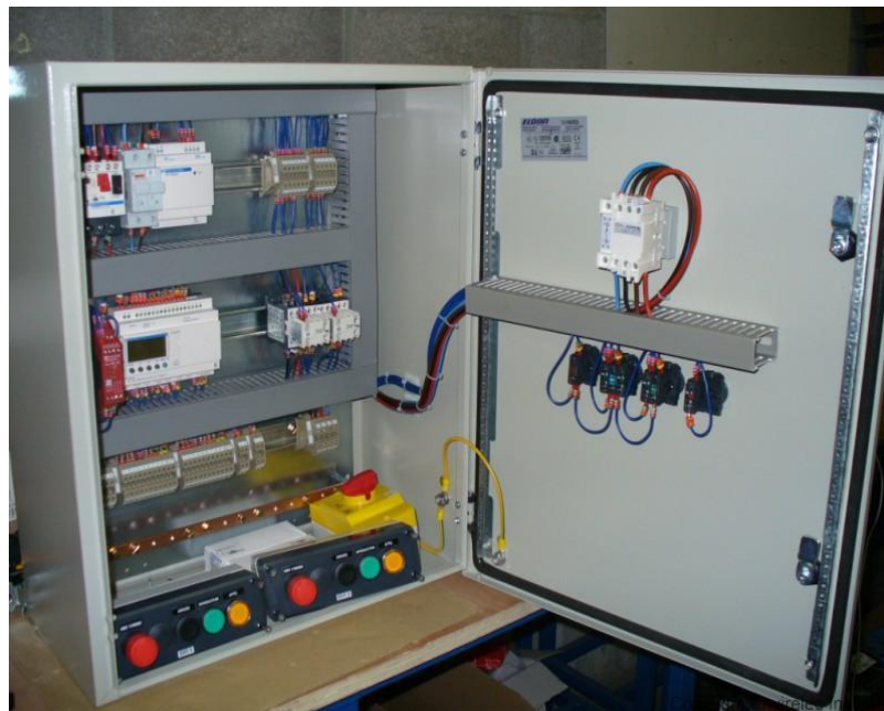
Figure III.11. Partie commande réalisée par logique programmée [57].
