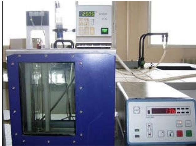
*Viscosimètre à capillaire utilisé type Ubbelohde*
