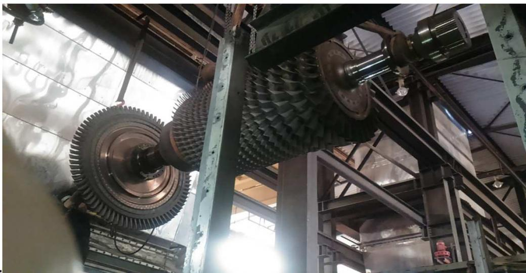
Figure VI.3. Rotor du compresseur axial avec la roue HP
