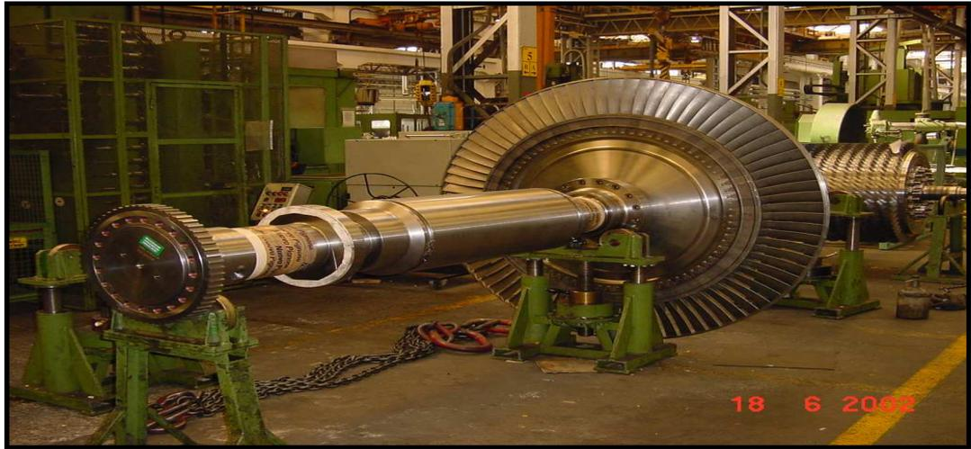
Figure VI.6. Vue du rotor de la turbine basse pression
